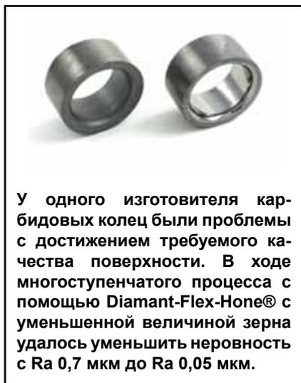
У одного изготовителя карбидовых колец были проблемы с достижением требуемого качества поверхности. В ходе многоступенчатого процесса с помощью Diamant-Flex-Hone® с уменьшенной величиной зерна удалось уменьшить неровность с Ra 0,7 мкм до Ra 0,05 мкм.
